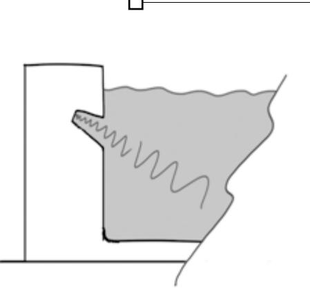
I micro getti dell'idromassaggio sono nascosti lungo la sottile fessura perimetrale, che caratterizza l'innovativo design della vasca.
