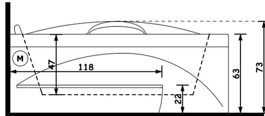
Motore Idromassaggio **M** Whirlpool Motor
